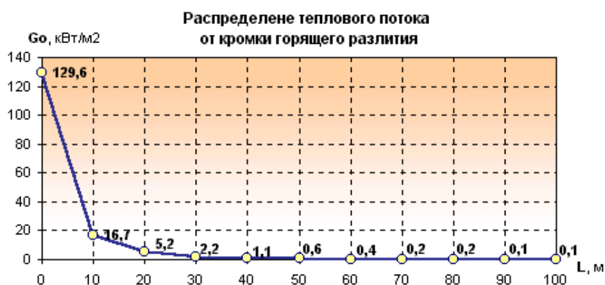
Рис. 5. Распределение теплового потока при горении разлива бензина по сценарию Рац
